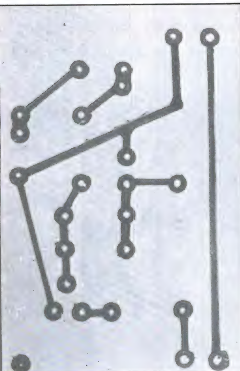
Afbeelding 3. Bij te hoge etstemperatuur of bij te lang etsen treedt er onderetsing op.
